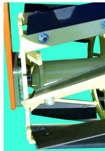
Die Messer der Actiroll sind bewusst schräg angestellt, dadurch wird der Effekt eines gezogenen Schnitts erzielt und ein gutes Arbeitsergebnis erreicht. Durch die variable Drehrichtung der Walze gibt es kein „verkehrt herum“. Je nach Richtung arbeiten die Messer mehr oder weniger aggressiv. Hochgewachsene Begrünung wird entweder nur umgelegt, oder eben abgeknickt und zerschnitten. Durch Erhöhen des Anpressdrucks kann der Effekt noch entsprechend verstärkt werden.
